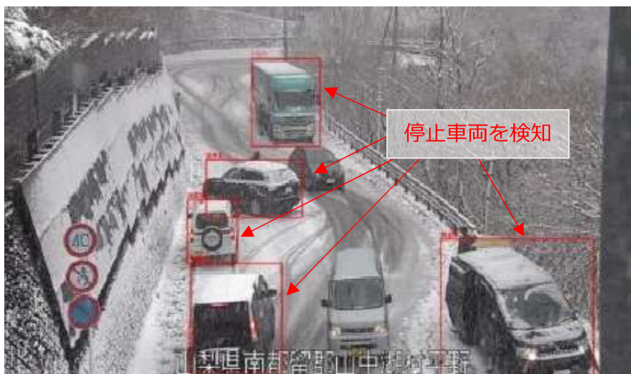
CCTVカメラを用いた交通障害自動検知システム
